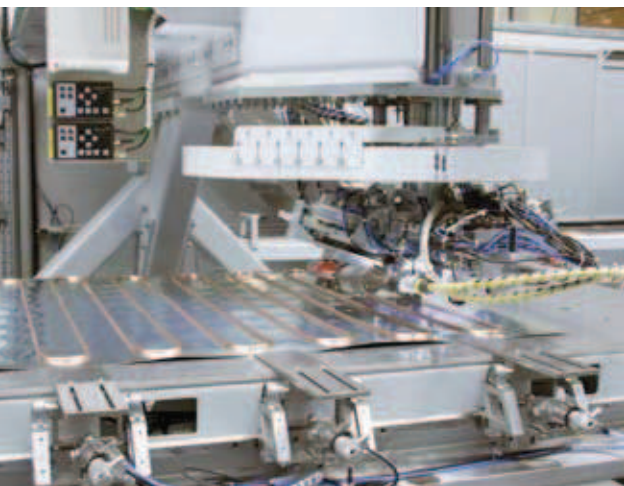
Der Bearbeitungskopf der Pulsspeed Bender-Produktionsanlage trägt die Laseroptik und ein Biegewerkzeug.
